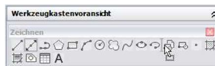
Abb.: Voransicht des Werkzeugkastens "Zeichnen", das Icon "Konstruktionslinie" wird im Bild umpositioniert.
